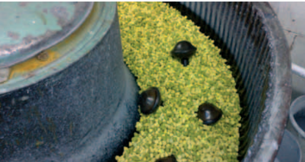
Rumble polishing Amalfine™ door knobs
